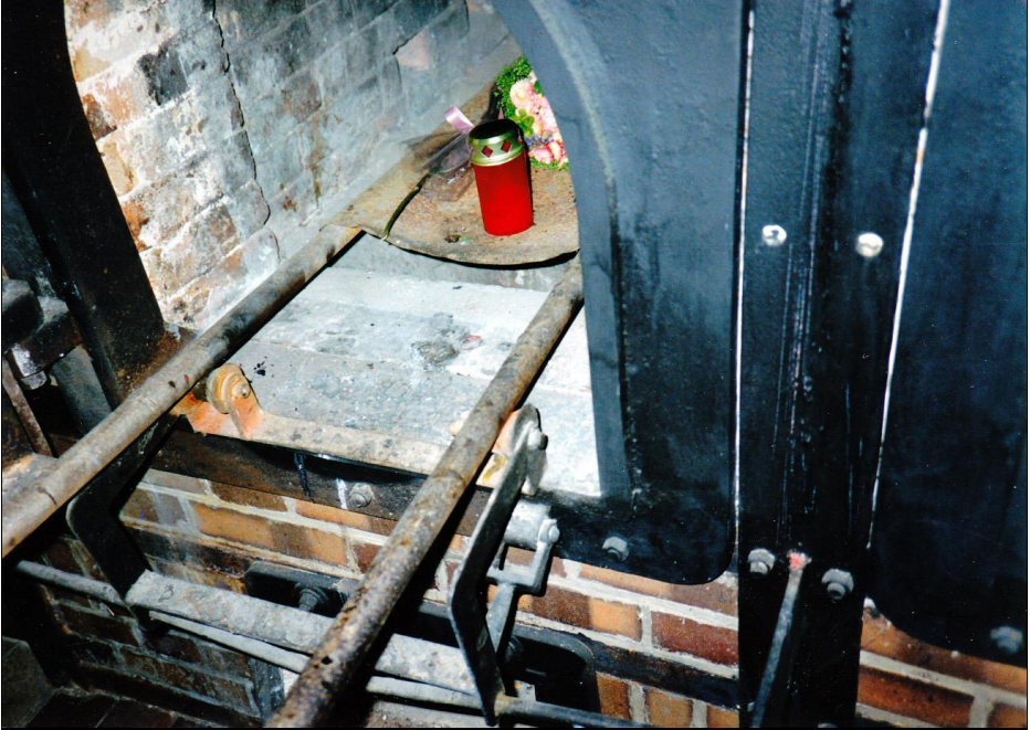
Dokument 12: Leicheneinführtrage in der linken Muffel des Topf-Doppelmuffelofens im KL Mauthausen, auf einem Paar Laufrollen ruhend. Mattogno/Deana, Teil 3, Foto 85, S. 71.
