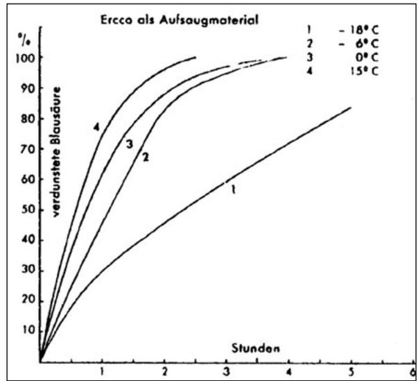
**Abbildung 3:** Verdunstungsgeschwindigkeit von Blausäure vom Trägermaterial Erco (Gips) bei verschiedenen Temperaturen (Irmscher 1942).
