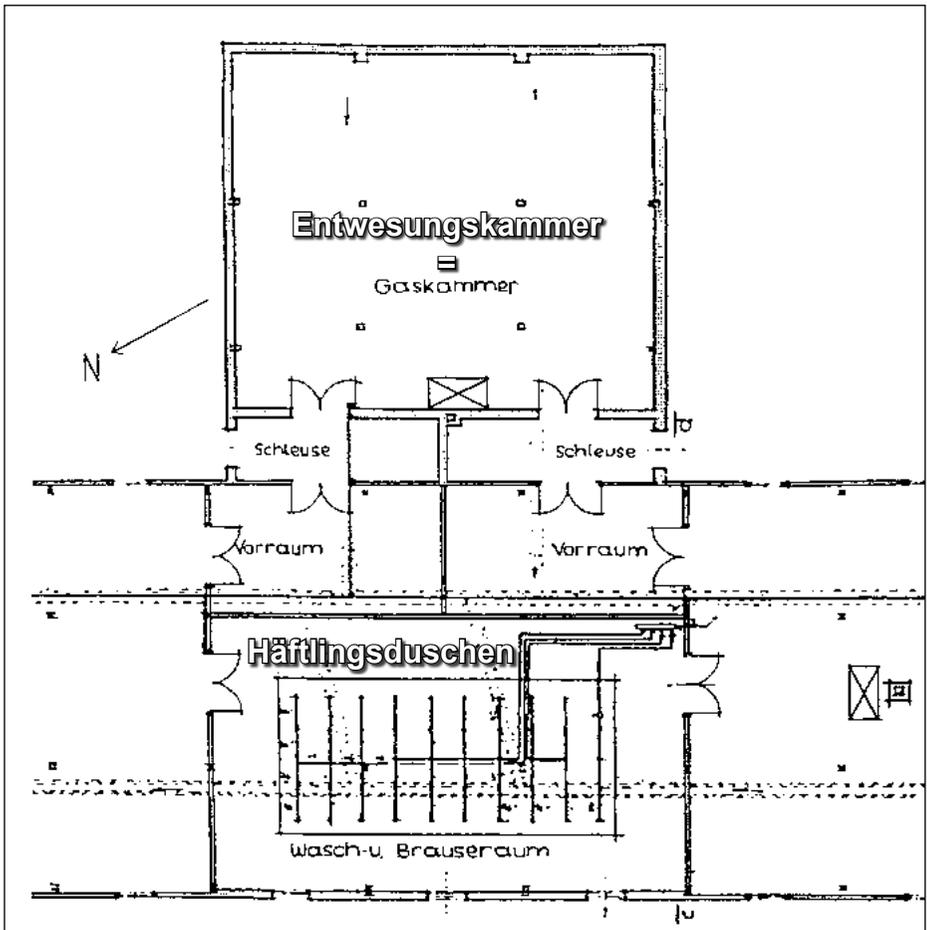
**Abbildung 27:** Bauwerk 5b im Lager Birkenau, Ausschnitt eines Bauplans vom 9. Mai 1942 (siehe S. 56). Die Anlage war u. a. ausgestattet mit einer Zyklon-B-Entwesungskammer und Duschen für Insassen. Das deutsche Wort für Entwesungskammer: „Gaskammer“.
