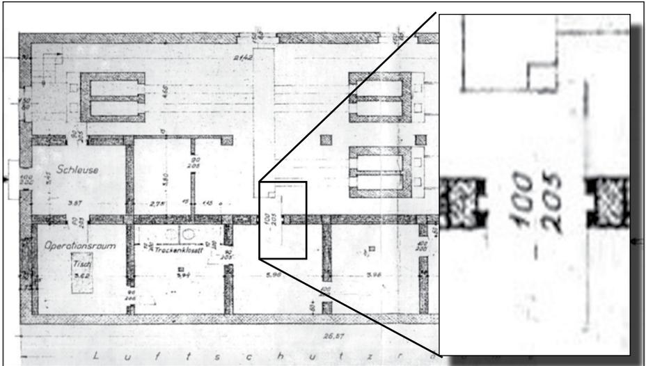
**Abbildung 22a&b:** SS-Bauplan des Krematoriums I vom 21. September 1944, der ebenso deutlich eine Pendeltür zeigt (obgleich in umgekehrter Richtung) zwischen der Leichenhalle (unten) und dem Ofenraum (oben). Siehe Ausschnittvergrößerung in der Einfügung.
