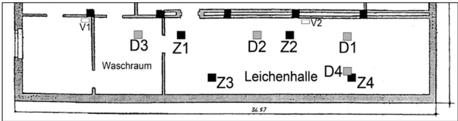
**Abbildung 15:** Ausschnitt eines deutschen Originalbauplans von Krematorium I, Zustand 1942, die Leichenhalle alias “Gaskammer” zeigend. Z1 bis Z4: Lage der heutigen Zyklon-B-Einfüllschächte. D1 bis D4 (graue Quadrate): ungefähre Lage der von Pressac “identifizierten” Vertiefungen. V1&2: Backstein-Lüftungsschächte, siehe Abb. 14.
