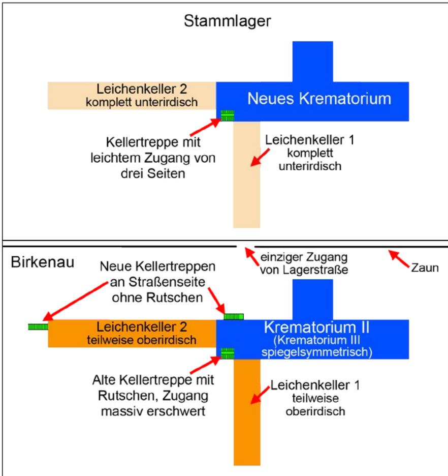
**Abbildung 51a&b:** oben: Schematische Lage des neuen Krematoriums wie ursprünglich für das Stammlager Auschwitz geplant. Unten: Schematische Lage von Krematorium II, veränderte Planung, um es an die höhere Lage der Leichenkeller und den Zugang in Birkenau von der anderen Seite anzupassen (Krematorium III gespiegelt).
