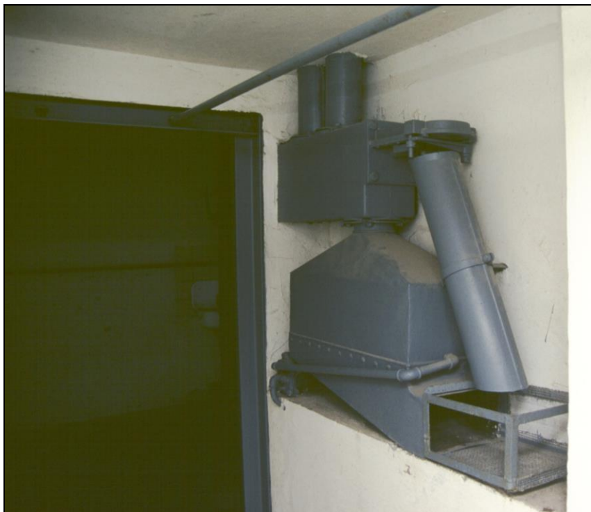
Abbildung 23: Das Innere einer der vier Degesch-Entlausungskammern, wie sie noch heute im Lager Dachau besichtigt werden kann. Oben der von außen bediente Dosenöffner. Das Zyklon-Granulat rutschte durch das Rohr in einen Drahtkorb, durch den ein Gebläse warme Luft blies (unter dem Dosenöffner).
