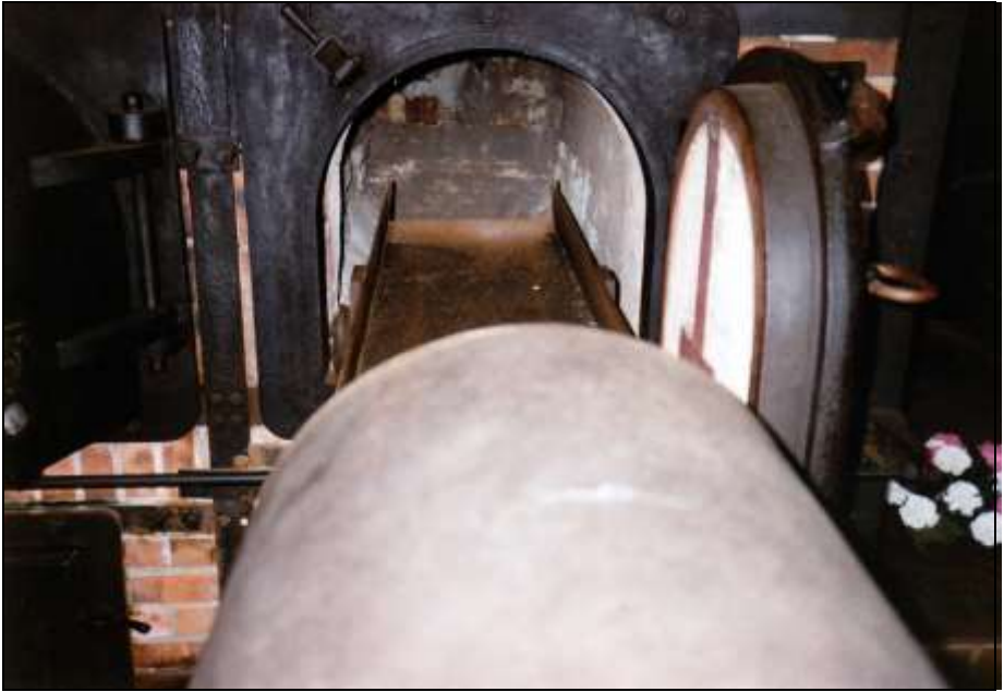
Foto 185: Blick über den Leicheneinführwagen hinweg, mit Leichentrage in der Muffel.
