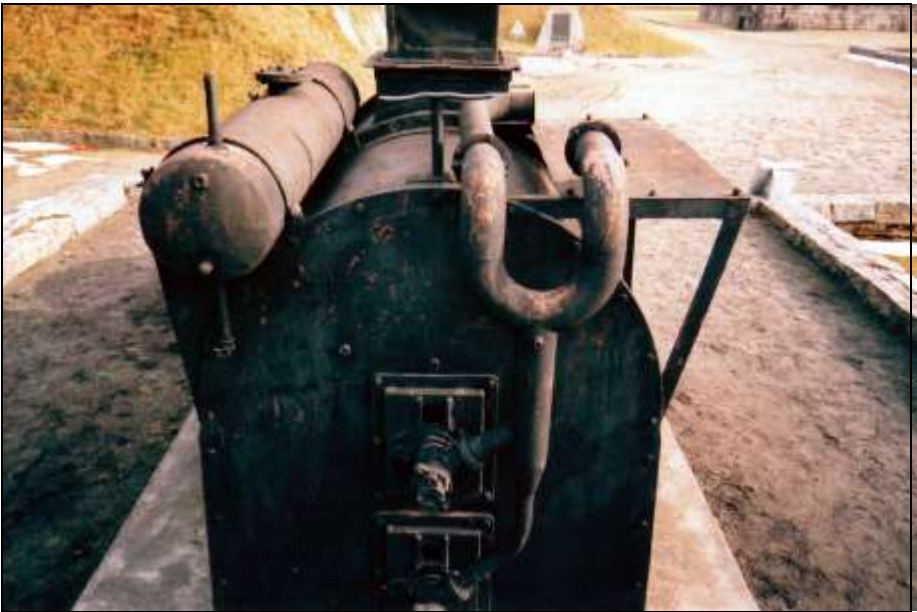
Foto 333b: wie zuvor. Die Luftleitungen waren ursprünglich an ein Gebläse angeschlossen, das auf dem Gestell rechts montiert war.
