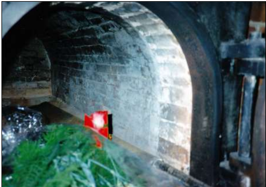
Foto 55: Rechte Muffel. An der rechten Muffelwand sind vier Zutrittslöcher für die Verbrennungsluft sichtbar.
