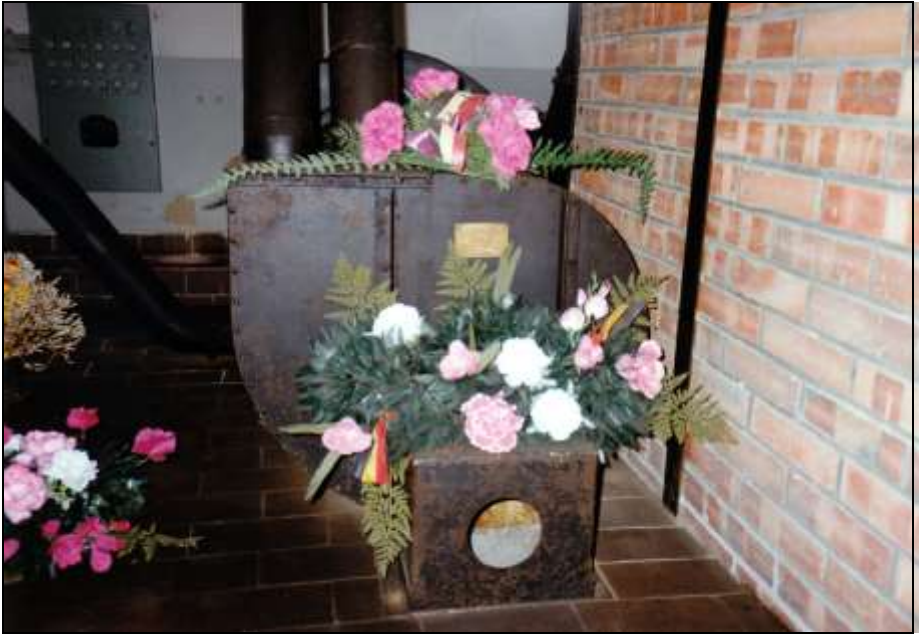
Foto 189: Druckluftgebläse zur Verbrennungsluftzufuhr, Vorderansicht; die linke Leitung mündet in den öl- bzw. koksbeheizten Ofen, die rechte in den koksbeheizten Ofen (siehe Foto 188).
