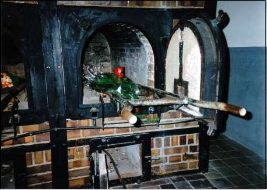
Foto 70: Rechte Muffel mit geöffneter Aschentür.
