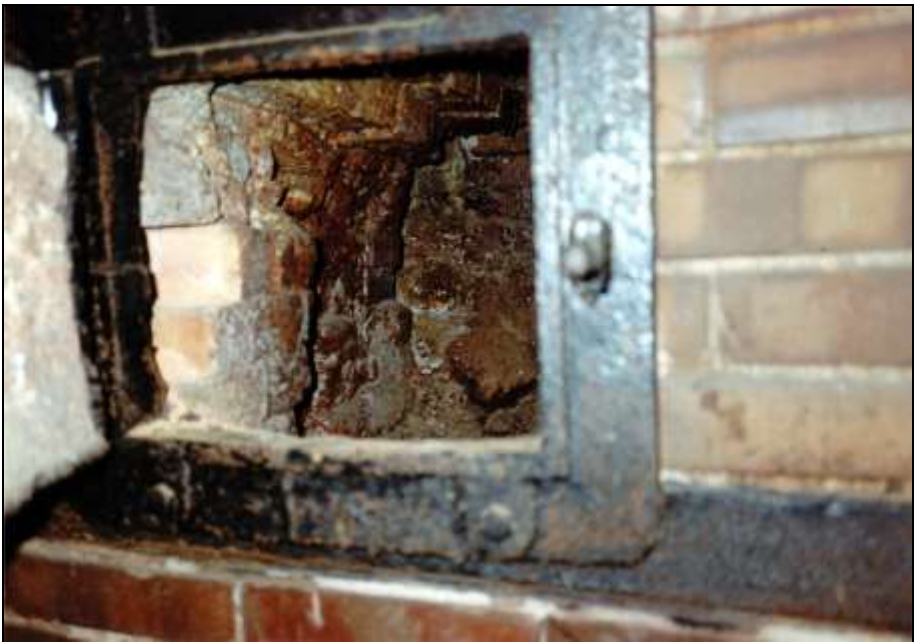
Foto 9: Rechter Generator: Koksfülltür.
