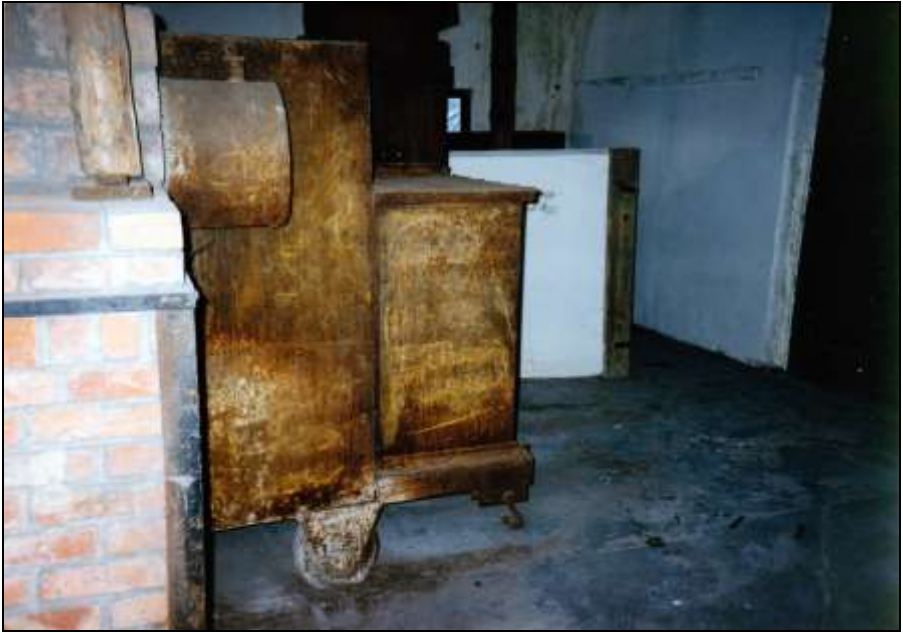
Foto 46: Rückseite des Ofens, von rechts gesehen: Öltank (oben links) und Stahlräder des Ofenkörpers (unten).
