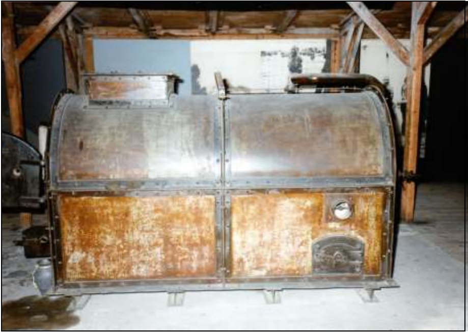
Foto 326: rechte Seite; unten rechts: Reinigungstür unter dem Verbrennungslufteinlass.
