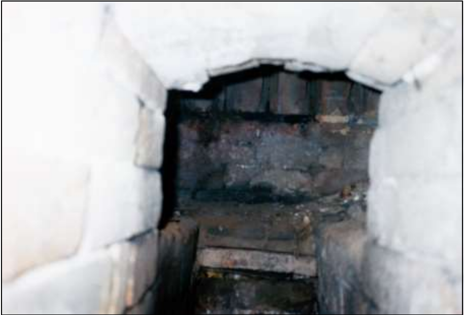
Foto 283: Rechter Ofen, das Innere des Hilfsgenerators mit der Wand der Muffel-Aschenkammer im Hintergrund und dem Muffelrost darüber.
