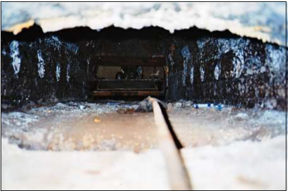
Foto 353: wie zuvor, mit herausgezogenem Leicheneinführwagen. Im Vordergrund die Stange des Kratzers zum Entfernen von Kremierungsresten.
