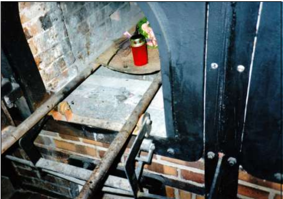
Foto 85: wie zuvor, von oben betrachtet: der verschiebbare Laufrollenrahmen, auf dem die Holme der Leichentrage ruhen.
