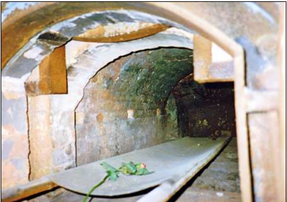
Foto 253: Zweiter Ofen, Muffelinneres; in der linken Seite befinden sich drei Öffnungen für die Verbrennungsluftversorgung.
