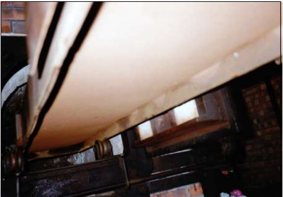
Foto 186: Leicheneinführwagen, Blick von unten. Kanten der Leichentrage, auf den Laufrollen gleitend.
