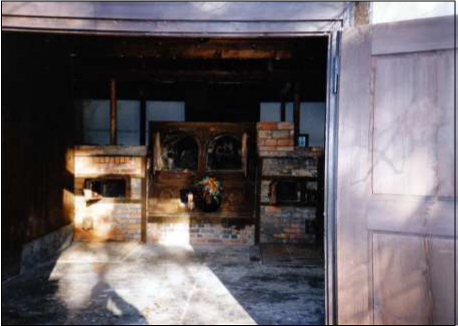
Foto 36 (oben) und 36a (unten): Ursprünglicher Ofenkörper aus beschichtetem Blech mit beidseitig angebrachten gemauerten Koksgasgeneratoren.
