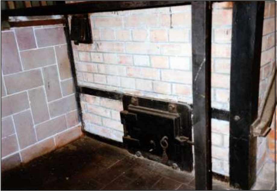
Foto 175: TOPF, koksbefeuerter Dreimuffel-Kremierungsöfen. Rückansicht, rechte Muffel: die Aschentür des Generators (unten) und die Klappe des Verbrennungsluftkanals zum Generator (oben links).
