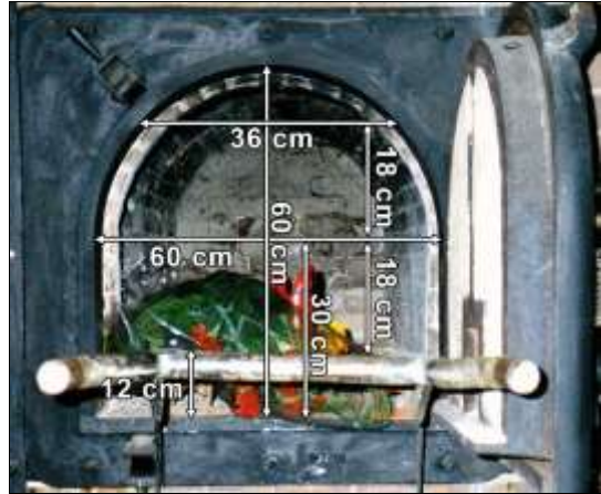
Abbildung 4: Muffeltür des Topf-Doppelmuffelofens im Lager Mauthausen, identisch mit den Türen der Doppel-, Drei- und Achtmuffelöfen in Auschwitz. © C. Mattoigno
