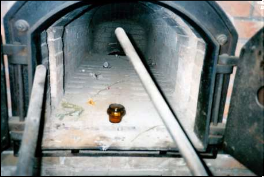
Foto 296: Der mittlere Ofen, Nahaufnahme der Muffel.
