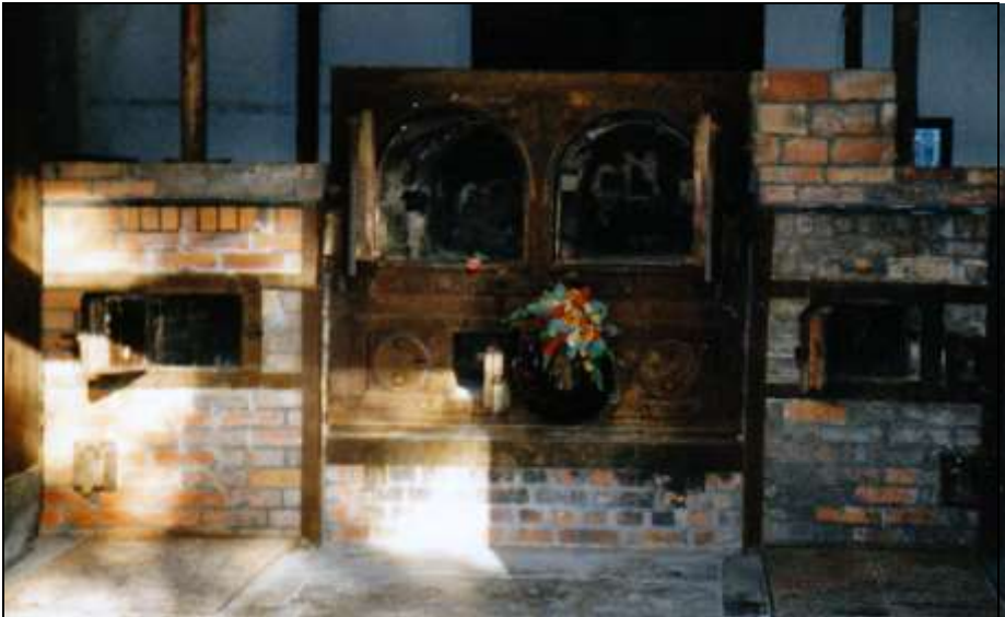
Foto 36 (oben) und 36a (unten): Ursprünglicher Ofenkörper aus beschichtetem Blech mit beidseitig angebrachten gemauerten Koksgasgeneratoren.
