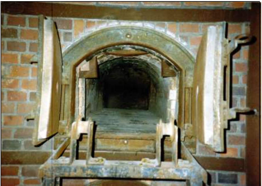
Foto 267: Erster Ofen. Muffel ohne Leichentrage und mit angehobener Schamott-Absperrplatte.
