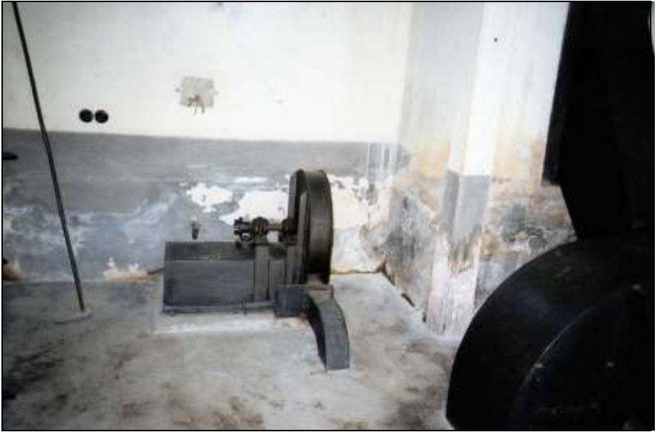
Foto 358: Verbrennungsluftgebläse des linken Ofens des vorderen Paares.
