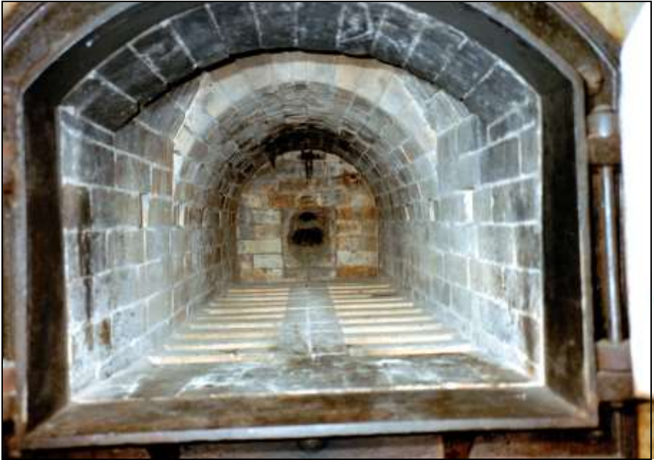
Foto 320: Muffelinneres. Unten: der Schamottrrost; an der Rückwand: die Düse des Hauptbrenners; an den Seitenwänden: Öffnungen der Verbrennungsluftkanäle.
