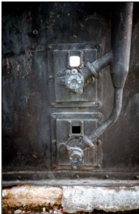
Foto 333c: Rückansicht, Haupt- (oben) und Hilfsbrenner (unten)
