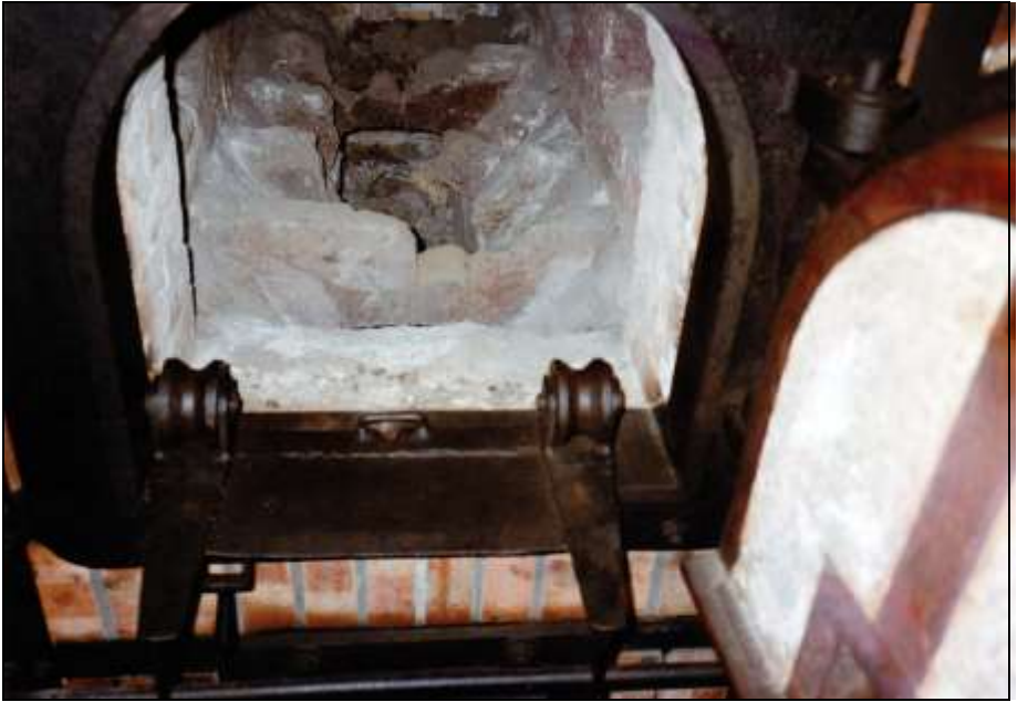
Foto 179: wie zuvor, beweglicher Lauffrollenrahmen, in Position gebracht.
