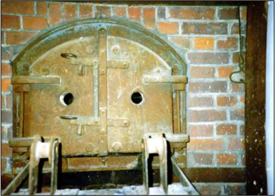
Foto 252: wie zuvor, Nahaufnahme der Muffeltür.
