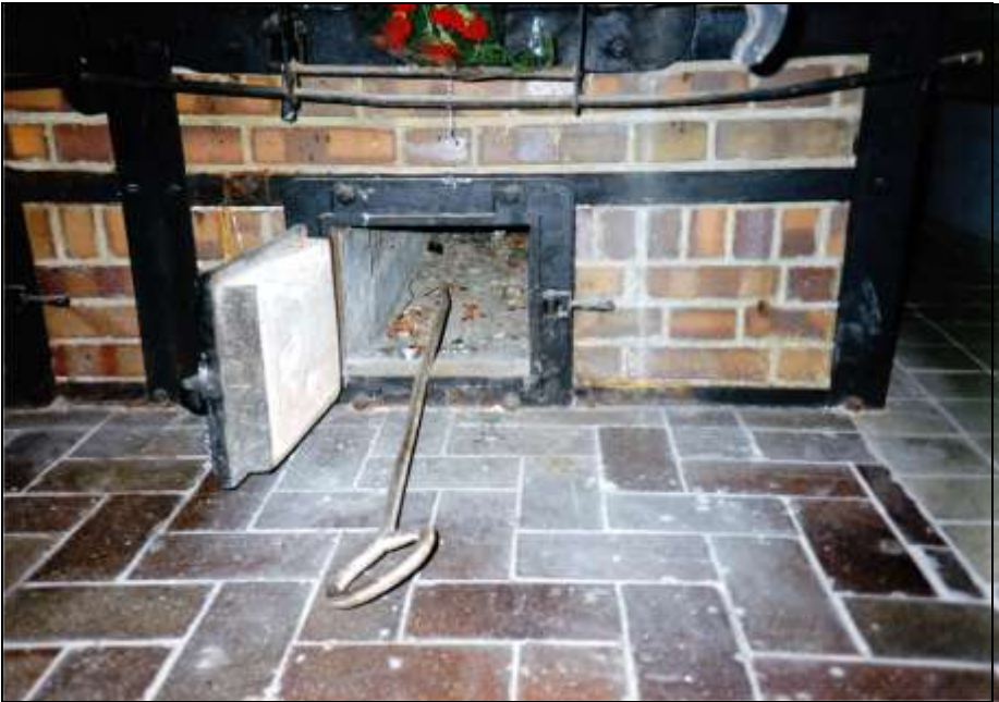
Foto 71: Aschenkammer der rechten Muffel.
