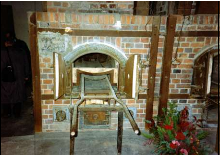
Foto 265: Zweiter Ofen, Vorderansicht. Muffel mit Leichentrage und abgesenkter Absperrplatte aus Schamott.
