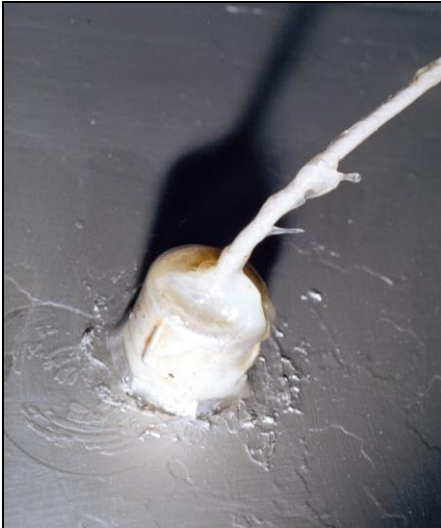
Abb. 112: Nahaufnahme des Eintrittspunktes eines Messkabels in das Innere der Kammer, bedeckt mit Vaseline.
