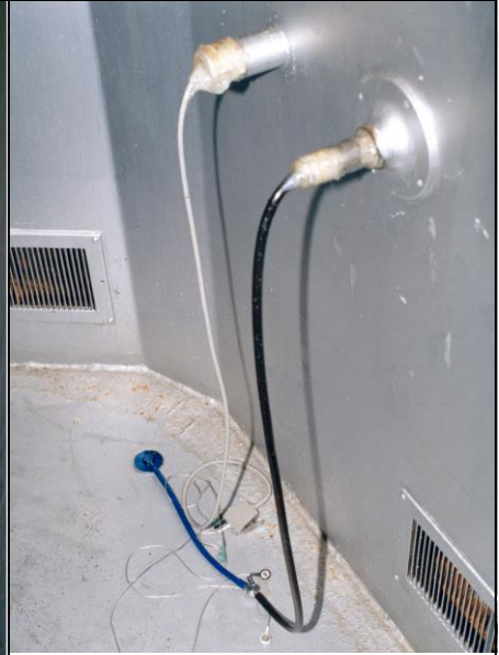
Abb. 111: Im Innern der Gaskammer, wo die Stethoskopleitung und andere Messkabel eintreten. Sie sind mit Vaseline bedeckt, um Lecks aufzuspüren. Rechts unten: Frischluftöffnung an der Wand nahe dem Fußboden.
