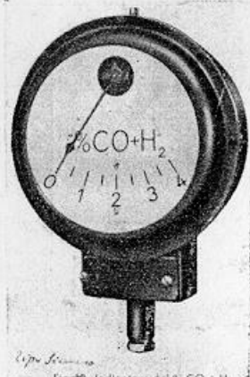
Fig. 234 bis. Indicatore del % CO 2 tipo in custodia ermetica (Siemens).
