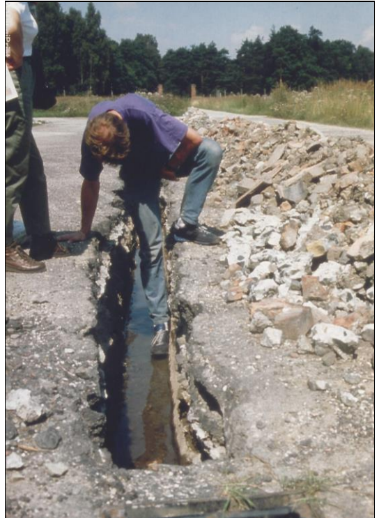
Abbildung 112: Grundwasserstand im Lager Birkenau im Hochsommer 1991 – in einem Baugraben mit dem Autor (Mitte) und Anita Philipp (links) vor der Zentralsauna: etwa 70 cm.
