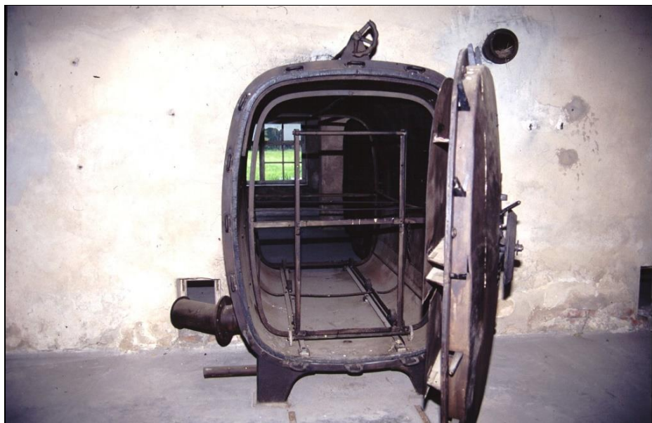
Abbildung 36: Autoklav für Dampfdesinfektion in der sogenannten "Zentralsauna" in Auschwitz-Birkenau (Leuchter et al. 2018, S. 252).
