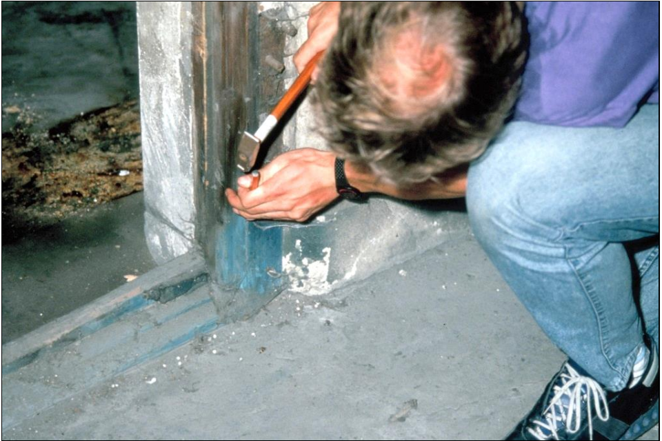
Abbildung 148: Aufnahme des Türpfostens aus dem Entwesungstrakt des Bauwerks 5a (zwischen Raum 2 und Raum 1 in Abbildung 41) mit dem Autor. Das untere, rostige Scharnier hat mit Blausäure Eisenblau gebildet. Entnahmestelle der Probe Nr. 18.
